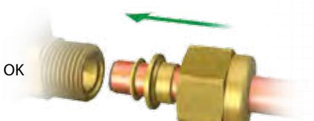
Innestare il tubo nel raccordo facendo scorrere dado (2), ogiva (4) e O-ring (3) prestando attenzione a non rovinare la guarnizione.
