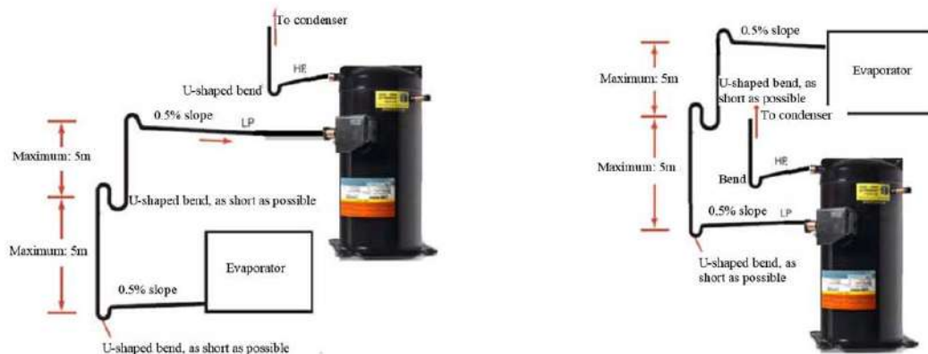
Рис. 5 Установка обратного потока масла
