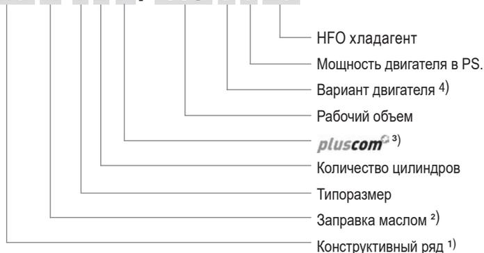
1) HG - Hermetic Gas-Cooled (с охлаждением газом на стороне всасывания)
